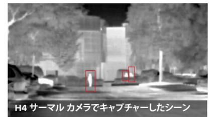
可視スペクトルを超えて動作する H4 サーマル カメラ シリーズは、視界の悪い領域、困難な照明条件、暗闇、部分的に偽装された場面などでも、光源を追加することなく、人や車両の動きを検知するように設計されています。Avigilon の自己学習型映像解析機能により、オペレーターは詳細調査を必要とする検知されたアクティビティの通知を受け取り、必要に応じて断固たる行動をとることができます。
